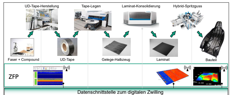
Einbindung der ZfP-Verfahren in die Prozesskette und den digitalen Zwilling
