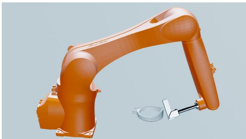
Abb. 4: Roboterpfad zur Inspektion eines Bauteils mit komplexer Geometrie. Der Pfad ist vollständig von entsprechenden Strömungslinien entlang der Bauteiloberfläche abgeleitet. Zusätzlich sind hier Roboterkinematik und Kollisionsvermeidung mitberücksichtigt.
