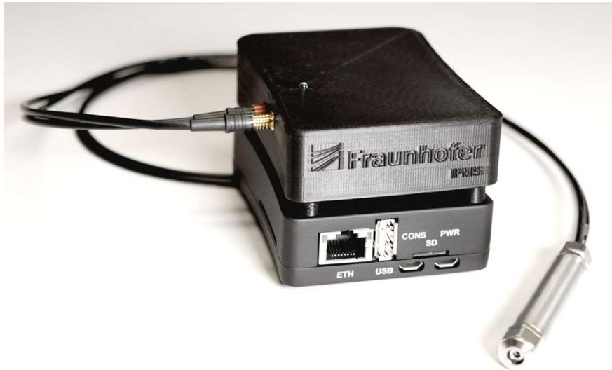
**Abb. 4.** Evaluation-Kit für CMUTs mit Red Pitaya Mikrocontroller-Board
