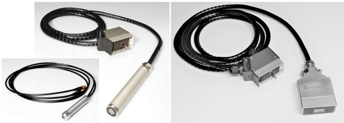
**Abb. 3.** CMUT-Prüfköpfe mit integrierter Vorverstärkerelektronik, links: Einzelelement-Sensor, Mitte: Annular-Array, rechts: Linear-Array
