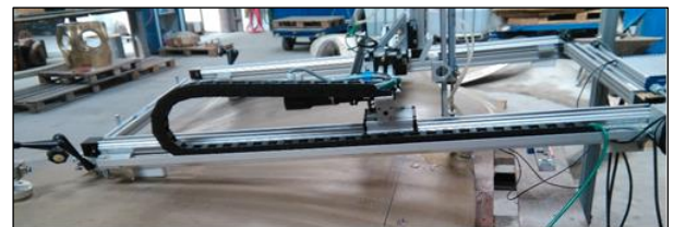
Scaneinrichtung in Rahmenbauweise über den Kantenbereichen
