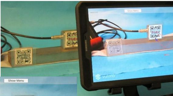
Oben: Laufende App auf einem Tablet. Das Videobild wird mit virtuellen Elementen überlagert.
