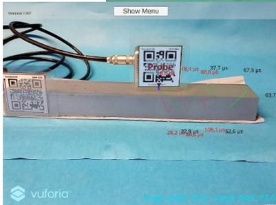
Links: Screenshot der App mit kleinem Einschallwinkel, z.B. bei Verwendung eines PA-Prüfkopfes, bei dem neben der Long-Welle (grün) auch eine Trans-Welle (rot) erzeugt wird.
