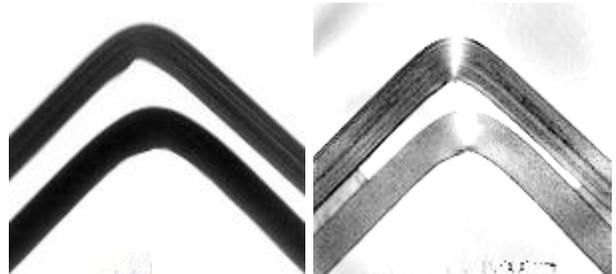
Abb. 3: AC des RayScan 250E (links) und DFC als Modalität aus der Talbot-Lau Gitterinterferometrie (rechts); Ergebnisse des Vergleichs eines unbeschädigten CFK-Winkel (jeweils unten) mit einem vorgeschädigten CFK-Winkel (jeweils oben)
