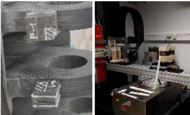
Abb. 1: Bauteilausschnitt für multiskalare Charakterisierung (links), Aufbau des Talbot-Lau Gitterinterferometers zur multimodalen Charakterisierung (rechts)
