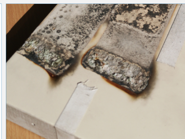
Abb. 4: Ausschnitt einer mittels Laser-Dekontamination teilweise bearbeitete Beton-Probe
