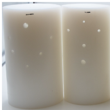
Vollrohre mit eingebrachten Bohrungen
