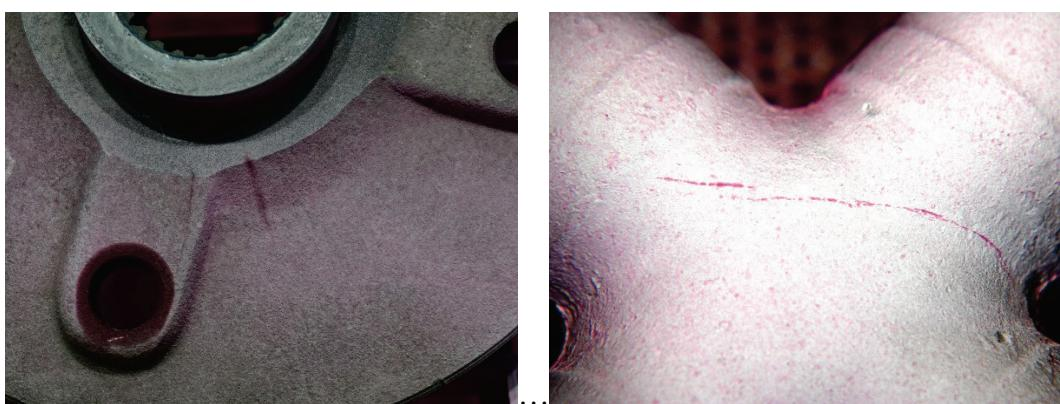
**Abb. 10.** Prüfergebnisse mit der Farbeindringprüfung (Rot/Weiß). Der Entwicklerauftrag auf einem Schmiedeteil ist unzureichend. Der Kontrast zwischen Hintergrund und Anzeige ist erheblich reduziert (links). Die gleichmäßig deckende Entwickler-Schicht auf dem Gussteil sorgt für einen guten Farbkontrast (rechts).
