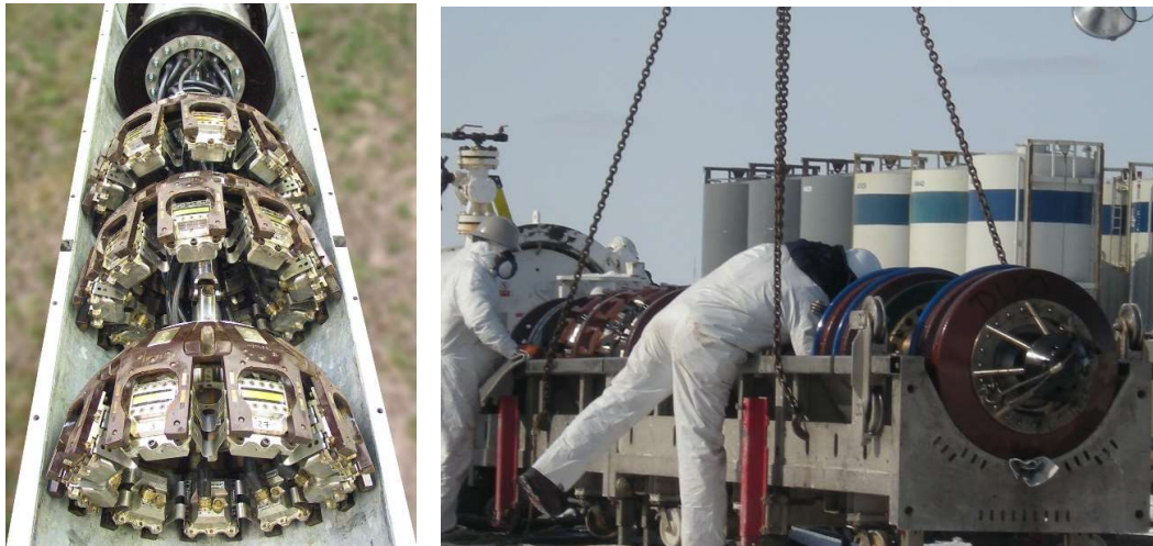
Abb. 1. UltraScan™ DUO - Blick auf die Sensorträger mit den Phased-Array-Prüfköpfen (links) und das Ausschleusen des Molches nach einem Inspektionslauf (rechts).
